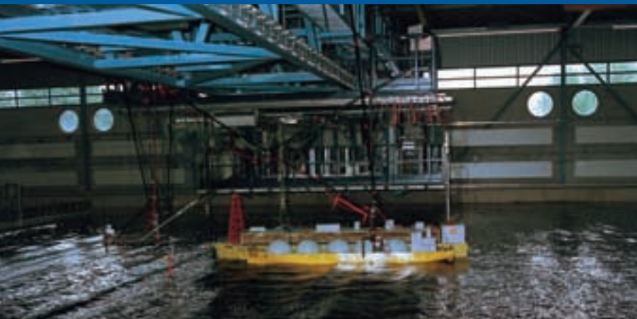
Offloading test with weather-vaning LNG barge and alongside berthed LNG carrier.
